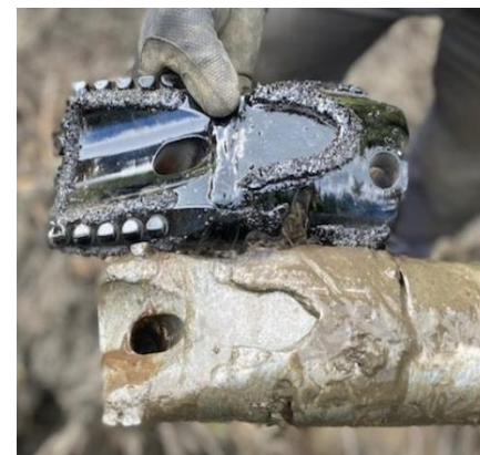
Tête de forage neuve à côté d'une tête de forage usagée qui a été utilisée pour forer dans la roche dure.
